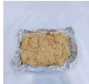
Setelah perendaman dengan \text{NaOH} 17,5 % pada suhu 50 °C selama 30 menit ( delignifikasi )
