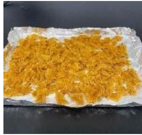
Setelah perendaman dengan \text{HNO}_3 3,5 % + 10 mg \text{NaNO}_2 pada suhu 90 °C selama 2 jam
