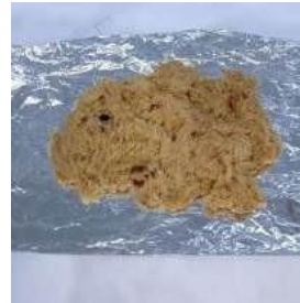
Setelah perendaman dengan \text{NaOH} 2 % + \text{Na}_2\text{SO}_3 2 % pada suhu 50 °C selama 1 jam
