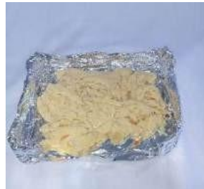
Setelah perendaman dengan \text{H}_2\text{O}_2 10 % pada suhu 60 °C selama 15 menit ( bleaching 2)
