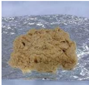
Setelah perendaman dengan \text{H}_2\text{O}_2 10 % pada suhu 60 °C selama 15 menit ( bleaching 1)
