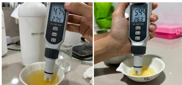
Gambar 2. Pengujian pH larutan Tisu Basah
